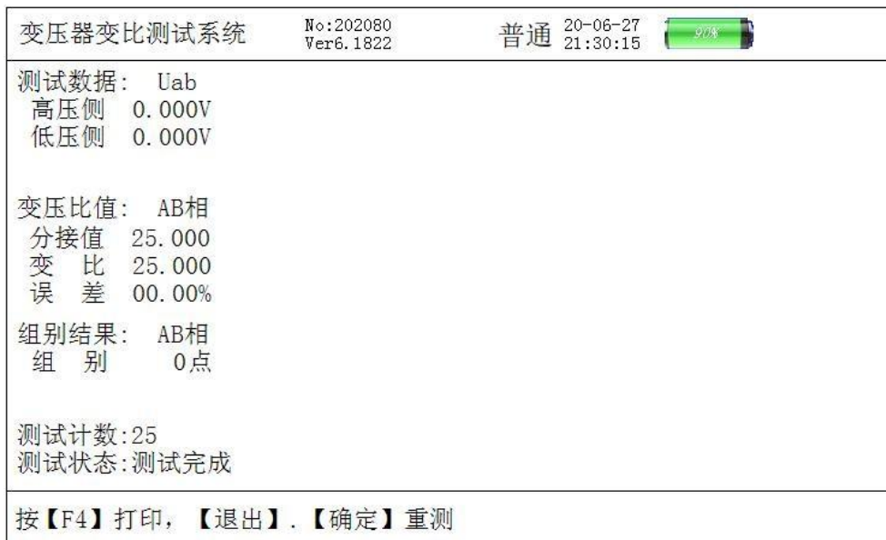
图十、单相变压器测试接线结果屏
